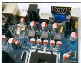
處理器供電採用四相全固態以及封閉式電容。
